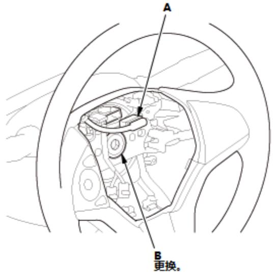
4. 在方向盘 (B) 上安装市售方向盘拔出器 (A)。
