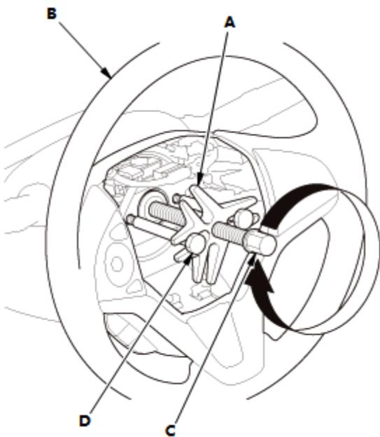
6. 拆下方向盘拔出器。
